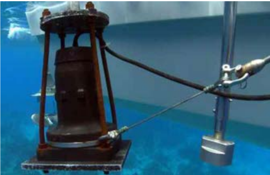
رسم صوتي فرعي للقاع (يسار) وجهاز قياس أعماق صوتي (يمين) مثبتة من جانب سفينة المسح. ومتصل بالرسم الصوتي للقاع كابل لنقل البيانات إلى جهاز كمبيوتر محمول على متن زورق في حين هناك كابل آخر لتثبيت المحول أثناء التجول على طول خط المسح. في حين كابل جهاز الأعماق الصوتي مثبت داخل أنابيب معدنية متصلة بالقارب
